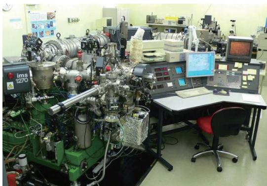
図1 高感度高質量分解能大型 SIMS
