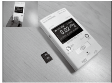
小型高精度ガンマ線検出器試作機
