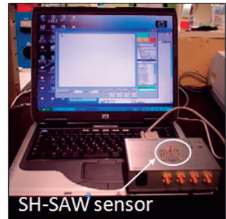
図5 開発した小型液体計測装置.
