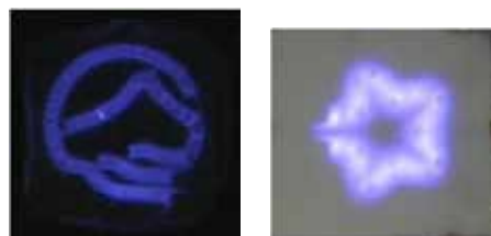
沿面放電 (平面プラズマ) の発光パターン例：(左：星型、右：静岡大校章 (富士山と駿河湾))
