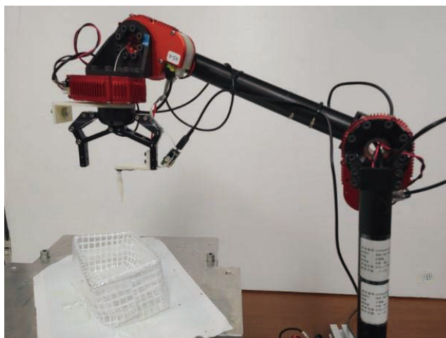
図1 力覚センサを搭載したロボットハンドによる箱の開口位置・姿勢の推定
